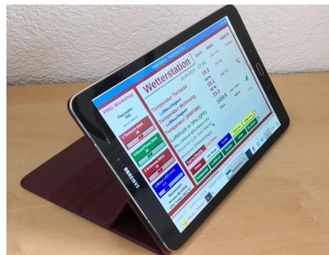
Die Bedienung erfolgt lokal mit einem Tablett via WLAN und 'remote' mit Tablett oder Smartphone über das Internet.
