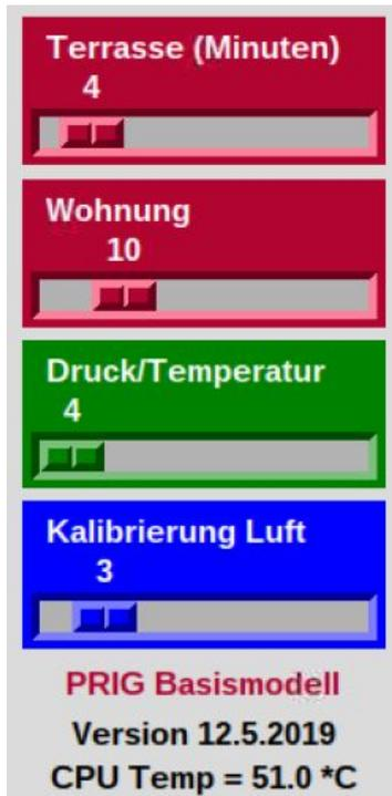
Auf dem Steuerbereich links sind 4 Schieberegler sichtbar zur individuellen Steuerung des Abfrage-Intervalls der verschiedenen Sensoren.
